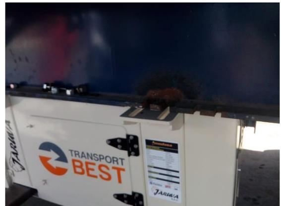
Motor y alternador de gran desempeño preparados para soportar diferentes condiciones ambientales. Potencia de 21 kW estándar. Módulo de control diseñado para generar y enviar reportes de parámetros de motor y alternador, permite informar del consumo de combustible, carga, frecuencia, horas de trabajo, paradas, entre otros. Envío de alertas críticas y preventivas de todo el equipo, complementado con un sistema de monitoreo remoto y de ubicación en tiempo real.
